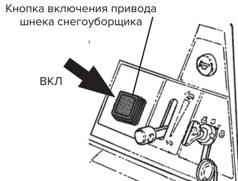
7. Переведите рычаг регулировки оборотов двигателя в положение «Высокие обороты».
