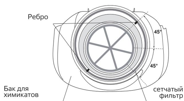
Установка и снятие сетчатого фильтра выполняется путем размещения его внутреннего ребра параллельно или перпендикулярно баку для химического реагента.
