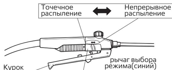
(1) рычаг выбора режима в положении точечного распыления
